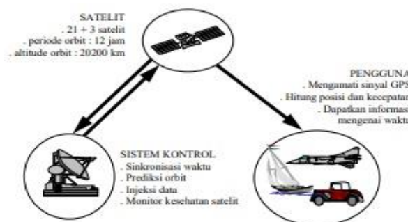
Gambar iv. Sistem GPS yang melibatkan Satelit, Sistem Kontrol dan Pengguna.
